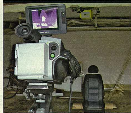
Die Wärmebildkamera erkennt die Temperaturverteilung
