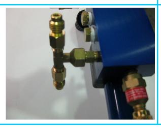
Adapter an das T,- Stück schrauben und T,- Stück an den Manometer Block montieren
