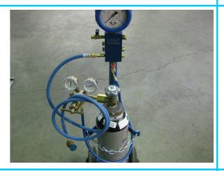
Ansicht des Druck- und Dichtheitsprüfgerätes vor der Montage des Erweiterungssatzes.
