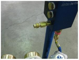
Blauen Schlauch am Druck- und Dichtheitsprüfgerät entfernen.
