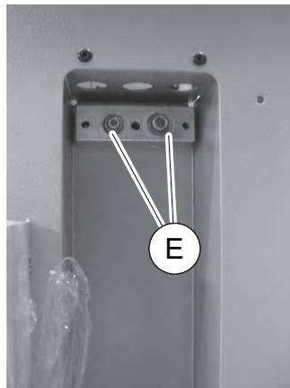
13. Inserire un nuovo deumidificatore e serrare la vite con max 15 Nm.
