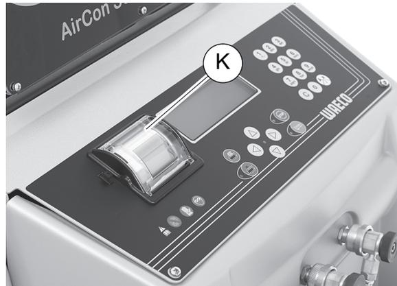
2. Coloque o rolo de papel novo conforme indicado e feche a tampa (K).
