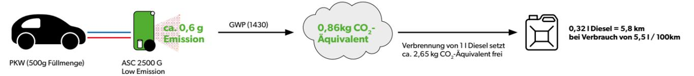
Der Klimaservice an einem durchschnittlichen Pkw (500 g Kältemittel Füllmenge) **mit einem WAECO Low Emission Klimaservicegerät** setzt ein CO<sub>2</sub>-Äquivalent frei, das mit der Verbrennung von nur circa 0,32 Litern Diesel vergleichbar ist.
